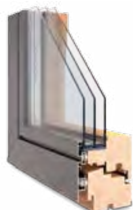
CUBE 116 Das Design Holz-Alu-Fenster mit höchstem Wärmedämmwert. Innen rahmenbündig, aussen glasbündig. 116mm Bautiefe
